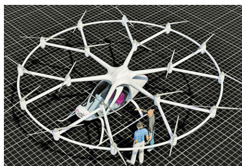
Gesteuert wird der Volocopter per Joystick. Fallen Propeller aus, reicht die Kraft der übrigen für den Weiterflug. Bild: SN/DPA
